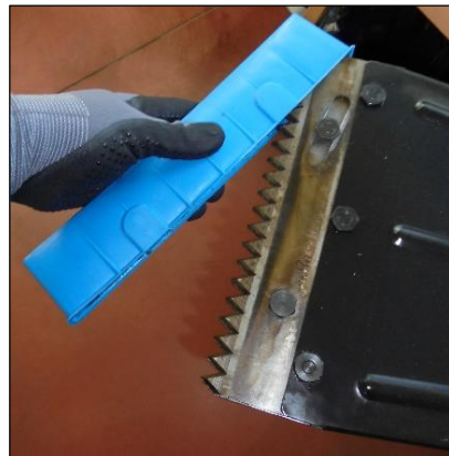
Abbildung 6 – Ziehen Sie die Schutzvorrichtung der Messer aus Plastik.
