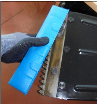
Abbildung 6 – Ziehen Sie die Schutzvorrichtung der Messer aus Plastik.
