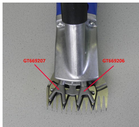
GT669206 + GT669207 FOURCHE DE PRESSION DROITE ET GAUCHE
