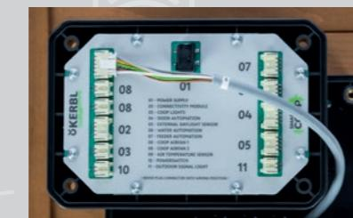
Sollte das am Modul verbaute Anschlusskabel in der Länge nicht ausreichen, so kann es mittels Verlängerungskabel (Art. 70633, 70634) verlängert werden. Achten Sie darauf, dass die Verbindungsstelle vor Wasser und Staub geschützt ist! Das Modulkabel darf max. 1x verlängert werden.
