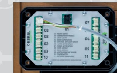
Se la lunghezza del cavo di collegamento installato nel modulo non è sufficiente, il cavo può essere allungato con una prolunga (art. 70633, 70634). Accertarsi che il punto di collegamento sia protetto dall'acqua e dalla polvere! Il cavo del modulo può essere allungato al massimo 1 volta.
