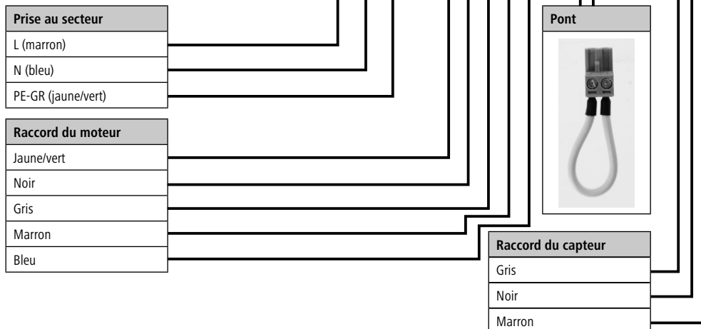
Figure 8 : Schéma de raccordement de la carte avec le condensateur
