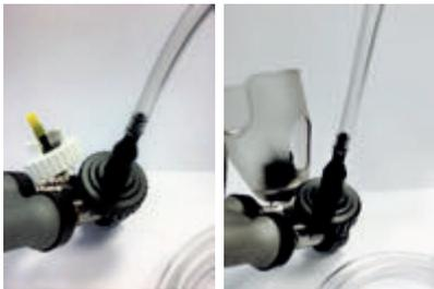
Si se utiliza el adaptador de tubo y de botella en mismo tiempo, se recomienda llenar en parte el cilindro con el adaptador de tubo antes del cilindro con adaptador de botella. Esto evita el desperdicio de vacuna por el cilindro con el adaptador de botella.
