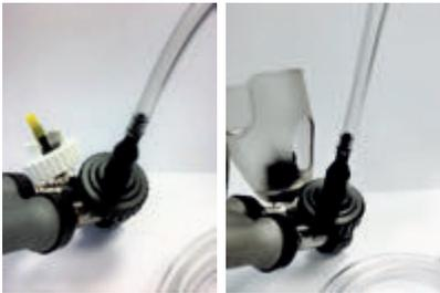
Quand usant en même temps l'embase de bouteille et de tuyau, il est recommandé de remplir partiellement le cylindre avec l'embase du tuyau avant le cylindre avec l'embase de flacon. Ceci empêche le gaspillage de vaccin par le cylindre avec l'embase de flacon.
